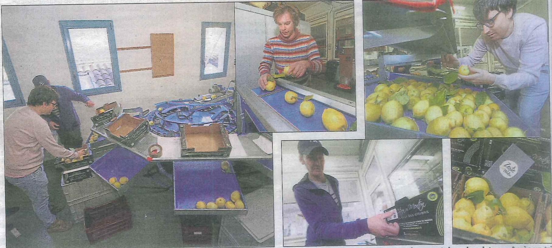
Les citrons sont placés un à un sur le tapis roulant de la calibreuse. Selon le poids et la taille, ils sont répartis automatiquement dans des plateaux. Après un tri visuel, les fruits sont conditionnés et pesés. Chaque caisse, qui sort de la station, est étiquetée pour des questions de traçabilité.
