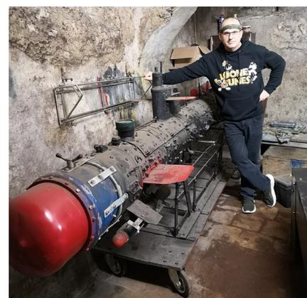
Le sous-marin (il lui manque seulement les flotteurs), « Le Nautilus MKT2 », il est électrique à plongée statique (avec une pompe à eau à engrenage), il fait 3m74 de long pour un diamètre de 315 mm et un poids de 150 kilos.
