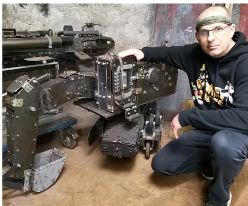
La tractopelle métallique (en cours de montage), « La H-2555-EX-45 », elle sera électrique et bénéficiera de vérins électriques pouvant délivrer chacun 150 kilos de poussée.
